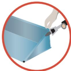
**10** Façonnage et soudure des talons
